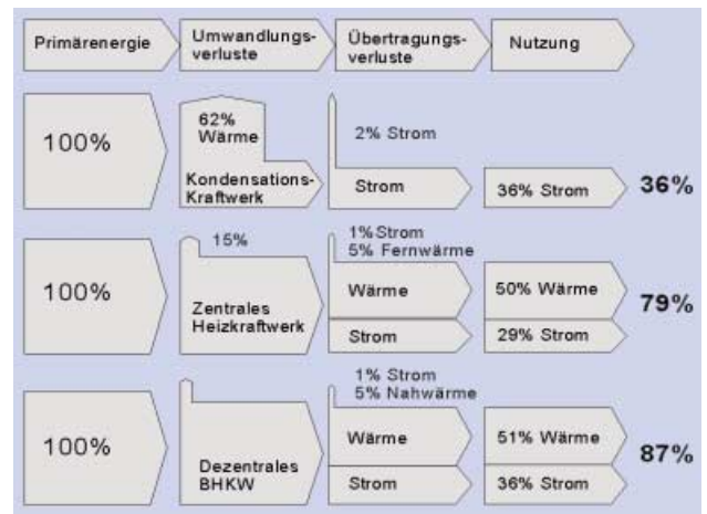
Abb. 1: Energieverluste bei unterschiedlichen Systemen zur Energiebereitstellung
